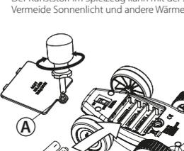
**Einsetzen und Wechseln der Batterien:** Dieser Rennwagen wird von 4 x AAA 1,5V Batterien angetrieben (nicht enthalten). Die Batterieabdeckung mit einem Schraubenzieher durch Lösen der Sicherheitsschraube (A) öffnen (siehe Abbildung). Die Batterien wie dargestellt einlegen (+/-). Batterieabdeckung schließen und die Schraube festziehen (siehe Abbildung).
